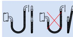
Schlauchleitungen so anordnen, dass diese nicht mit dem Boden, den Wänden oder sonstigen Gegenständen in Berührung kommen.
