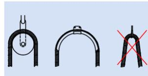
Schlauchleitung als 180°-Bogen mit ausreichenden neutralen Schlauchenden einbauen. Einbauabstand nach dem erforderlichen Biegeradius bestimmen.
