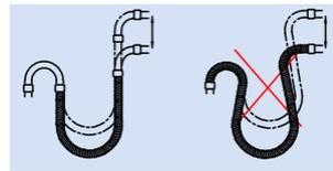
Bewegungsrichtung und Schlauchachse sollen in einer Ebene liegen. Schädliche Torsionsbeanspruchungen werden dadurch vermieden.
