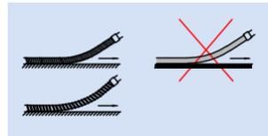
Schlauchleitungen verdrehungsfrei anschließen.
